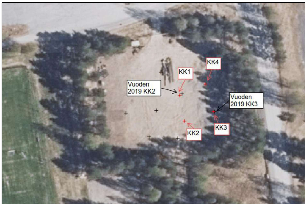
Kuva 3. Koekuoppien sijainnit kiinteistöllä, punaisella 21.11.2025 tehdyt koekuopat (4 kpl) ja mustalla vuonna 2019 tehdyt koekuopat.
